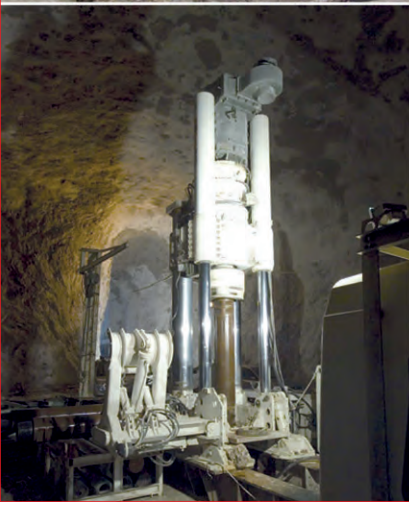
Raise Borer machine nell'esecuzione di un pozzo
